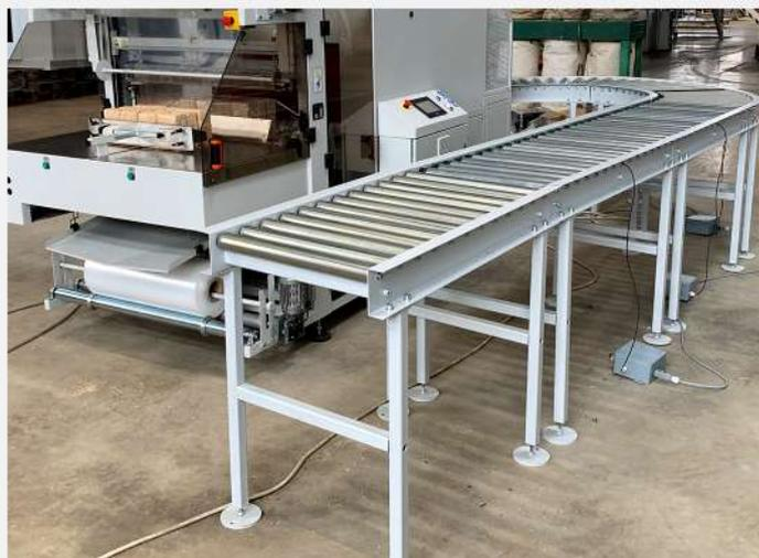
SAPS требует ручной загрузки брикетов и упаковки их в выбранную пленку определенной толщины. Он оснащен двухцепной системой лент для лучшей защиты от пыли и может использоваться для упаковки различных продуктов, таких как бутылки и упаковки сахара.
