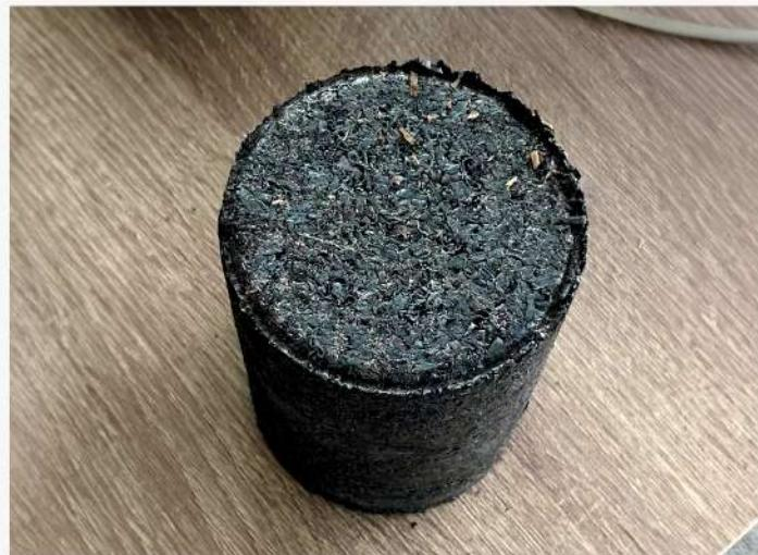
Металлические брикеты - это компактные блоки, изготовленные из металлической стружки или опилок с помощью пресса для брикетирования металла. Они уменьшают объем, улучшают плавление, экономят ресурсы и повышают безопасность на рабочем месте.
