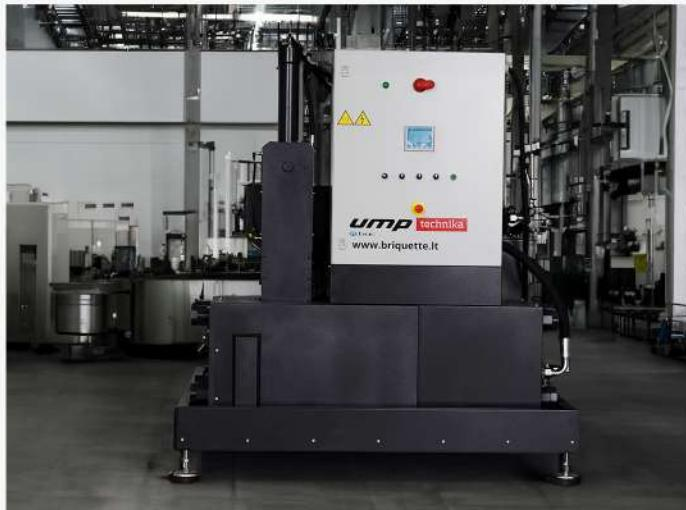
МВР - это специализированный пресс, предназначенный для брикетирования металлической стружки, опилок и сплавов. Пресс используется для производства металлических брикетов, которые легче использовать повторно, хранить и транспортировать, а также продавать.
