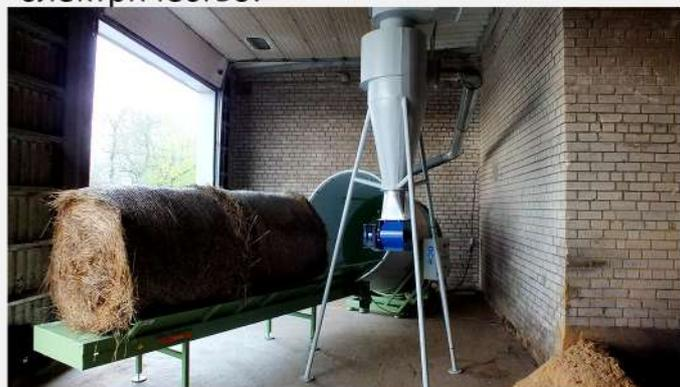
**Встроенный конвейер:** Встроенный конвейер длиной 4000 мм обеспечивает плавную и непрерывную обработку материала, значительно повышая производительность ваших операций по измельчению. Вам нужно только загрузить конвейер рулонами, а SS-D180 сделает все остальное.
