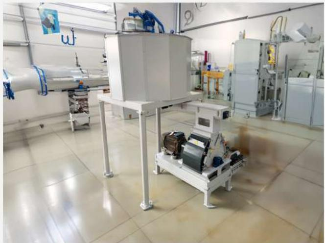
**Оптимальная эффективность:** шнековый питатель ММВ-2000 автоматически подает материал в молотковую мельницу в зависимости от ее текущей загрузки, оптимизируя энергоэффективность и производительность, обеспечивая непрерывную работу и минимизируя время простоев.
