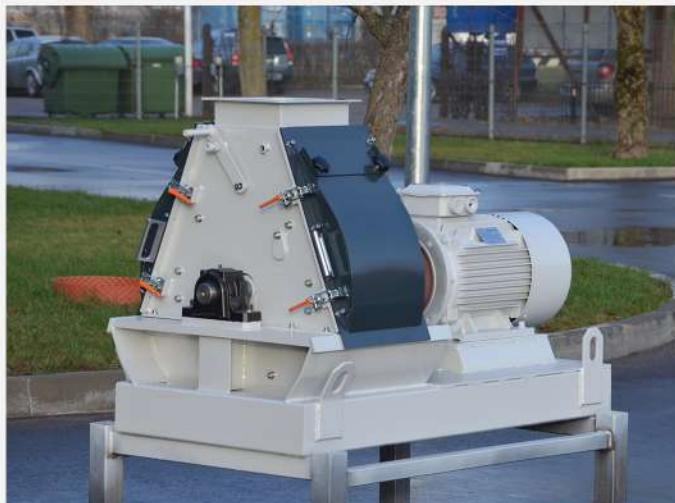
**Измельчение древесной стружки:** молотковая мельница ММ предлагает деревообрабатывающим предприятиям решение для превращения древесной стружки в опилки брикетировочного качества. Путем дробления и измельчения щепы через металлические сите она превращается в микростружку или опилки.
